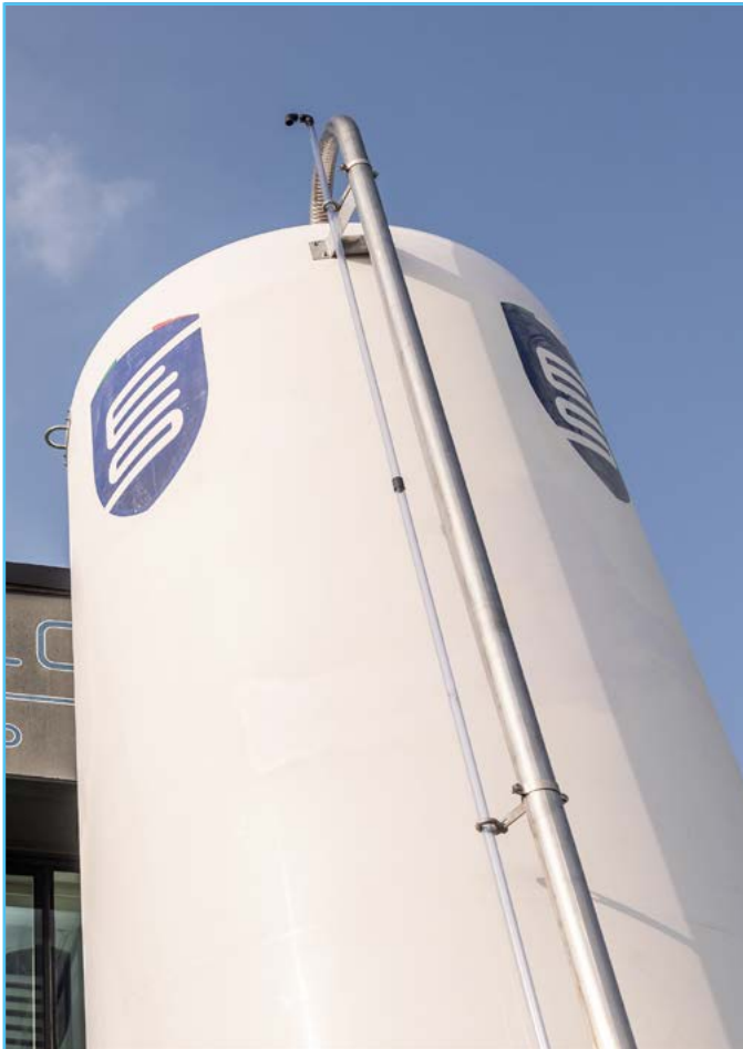
1 Tubo di livello trasparente Transparent level tube
