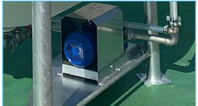
2 Pompa ad ingranaggi su basamento, accoppiata a motore elettrico, da 21-40-70 litri/minuto. Gear pump on a base, coupled with an electric motor, 21-40-70 liters/minute.
