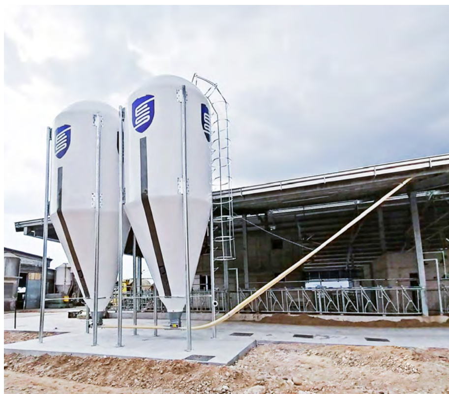
Ejemplo de instalación de silos de carga para un sistema de ordeño robótico con tornillo flexible: un diseño a medida según las necesidades específicas del cliente. Example of loading installation silos for a robot milking system with flexible auger: a tailor-made design according to the specific needs of the customer.
