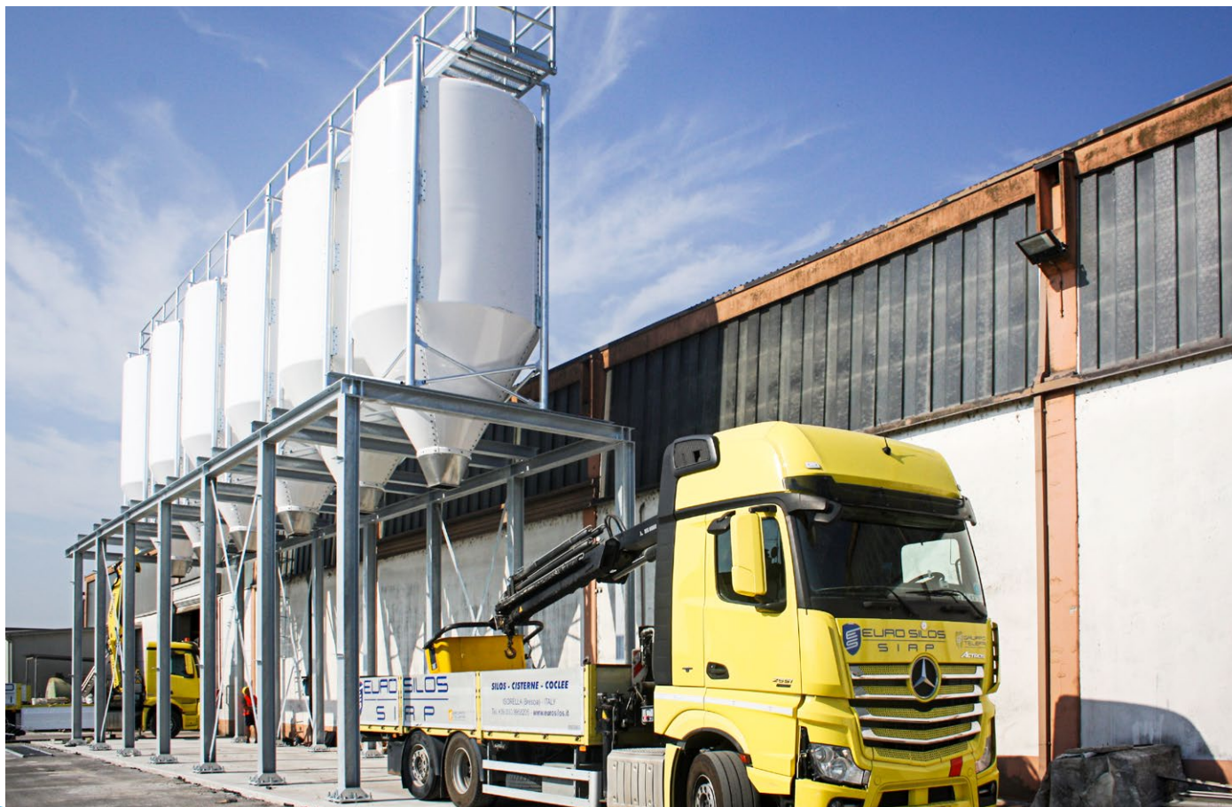
Estructuras de silo con sistema de descarga rápida para camiones Silo structures with quick unloading system for cargo
