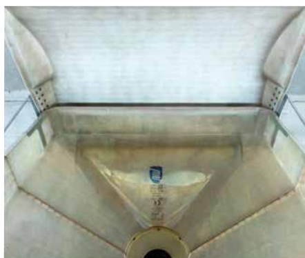
Superfici interne perfettamente lisce per uno scorrimento ottimale del prodotto
