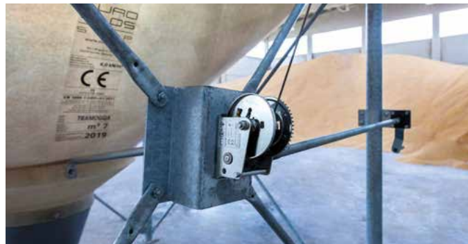
Il meccanismo di apertura con verricello laterale per operazioni di carico in totale sicurezza
