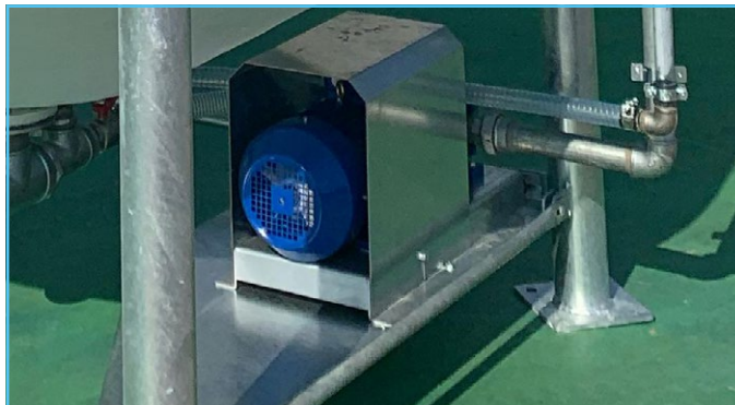
Bomba de engranajes sobre bancada, acoplada a motor eléctrico, de 21-40-70 litros/minuto Gear pump on a base, coupled with an electric motor, 21-40-70 liters/ minute
